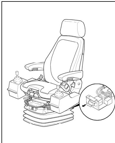
Nel caso che una componente elettrica sia difettosa deve prima essere controllata la protezione interna.
